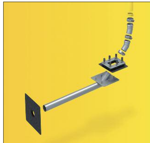
SitaKaskade Inside: Das normkonforme Bauteilsystem, das in der Waagerechten unsichtbar in die Wärmedämmung eingebettet wird. Ausgestattet mit angeschweißter Schraubflansch-Konstruktion zum sicheren Anschluss der Dachbahn und Bögen, die durch Sicherungsschellen fixiert sind.
