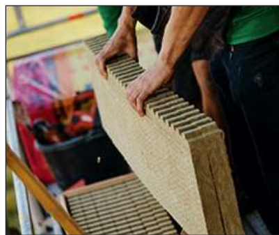
Der Kontur BR Brandriegel von ISOVER besteht aus einer schmalen Steinwolle-Platte mit einem speziellen Zähneprofil an der Vorderkante.
